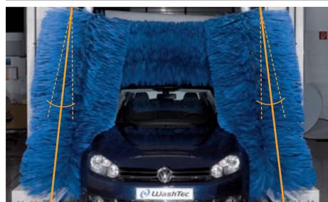
Pendant le lavage, les brosses latérales s'inclinent automatiquement pour s'adapter à la forme du véhicule et assurer un lavage impeccable.
